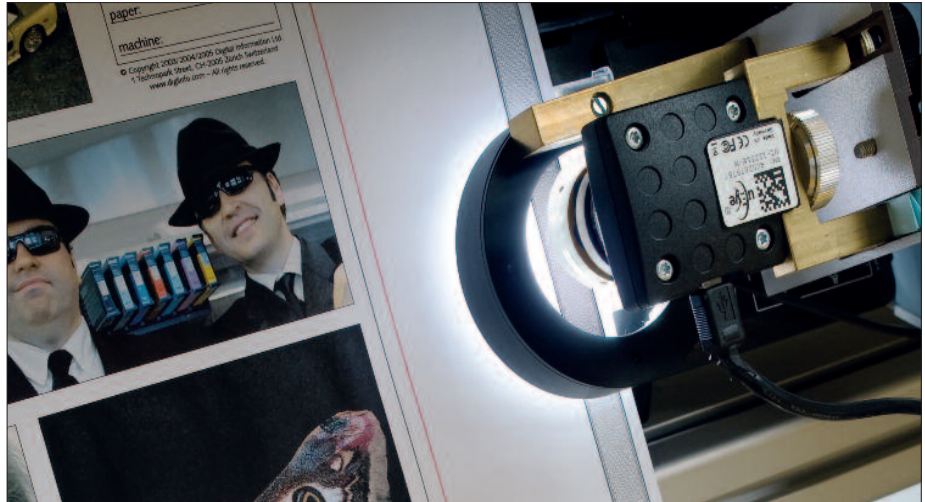
Das neuartige Kontrollsystem mit Videokameras erlaubt den Druck auf Vorder- und Rückseite mit hoher Registerpräzision bei ungeschnittener Papierbahn.
